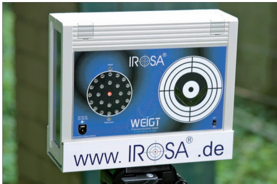
Empfänger und Zielkasten mit Zentrums-treffer (rote LED).
