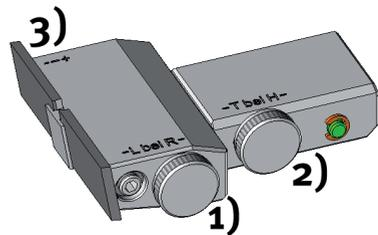
Die Kimmenbreite kann über die Stellschraube (3) mit einem Innensechskantschlüssel verstellt werden. Um den Abstand zu erweitern drehen Sie die Schraube nach links und zum Verringern nach rechts. Beide Kimmenblätter verstellen sich symmetrisch.
