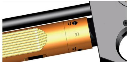
Bei der Montage der Kartusche an eine Luftpistole oder wieder an die Attrappe, achten Sie darauf, dass Mündung, Linse und Batteriefachdeckel eine gerade Linie bilden.
